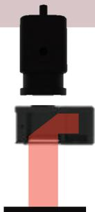
LED 粗糙晶粒表面導致光源漫射無法反射至CCD
