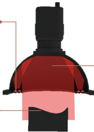
籠罩型照明四面八方投射間接光。由於可在形狀不規則的物體上均勻投射柔和的擴散光線，因而可讓表面情況保持不變，檢測點的對比度也隨之明顯。適合運用在不規則包裝紙及彎曲罐頭底部文字的檢查
