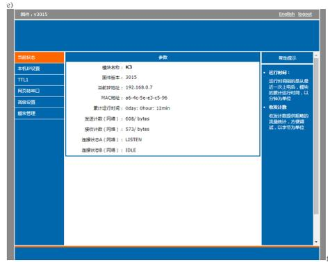
圖 2-2 設置串口參數，串口參數出廠已默認修改好，無需修改，預設為透傳協議。請根據實際需求進行修改，如下圖所示，可更改為Modbus TCP協議。
